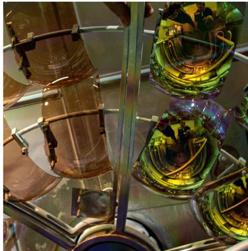
**10 – Chrombeschichtung** Für die Chrombeschichtung der Premiumscheiben wird eine spezielle Maschine benötigt, die eine Temperatur von 1'300°C im Vakuum generiert. Das Rohmaterial verdampft und die Scheiben werden beschichtet.
