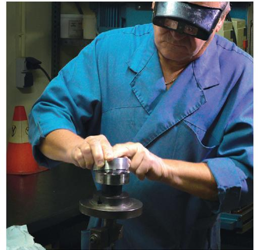
**8 – Manuelles Polieren** Vor jeder Injektionsphase müssen die mit CNC-Technologie hergestellten Pressformen von Hand poliert werden, um bei der Scheibeninjektion eine perfekte Endverarbeitung zu erzielen.
