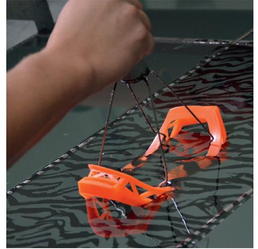
**17 – Wassertransfer** Grafikmuster werden auf ein bestimmtes Material gedruckt und anschliessend in ein Wasserbecken gelegt. Beim Eintauchen des Rahmens ins Wasserbad wird das Muster auf den Rahmen übertragen.
