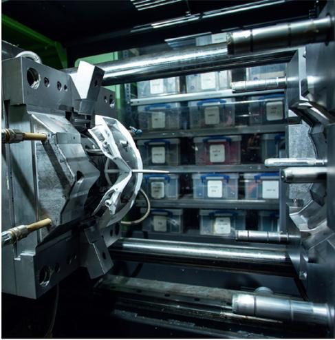
**15 – Rahmeninjektion** Für jede einzelne Komponente des Rahmens wie Fit System, Lens Change System oder Nasenschutz braucht es eine spezifische Injektion.
