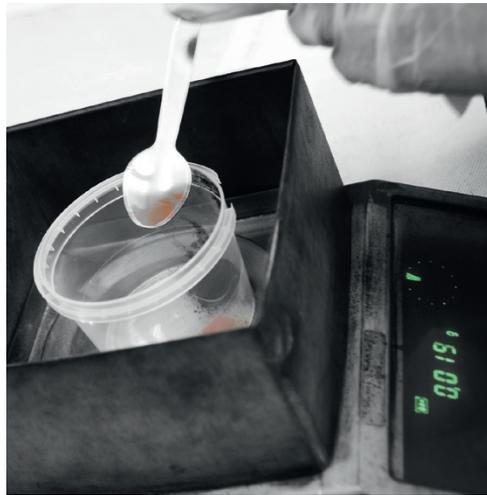
**7 – Pulvermischung** Das unverarbeitete Plastikmaterial kann mit der exakt bemessenen Menge Pigmentpulver vermischt werden, um die gewünschte Scheibentönung zu erzielen.
