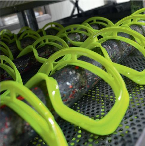
**18 – Lackierung und Trocknung** Durch das Besprühen mit Lack wird die Widerstandsfähigkeit der Dekoration sichergestellt. Nach der Trocknung sind die Komponenten für den Zusammenbau bereit.
