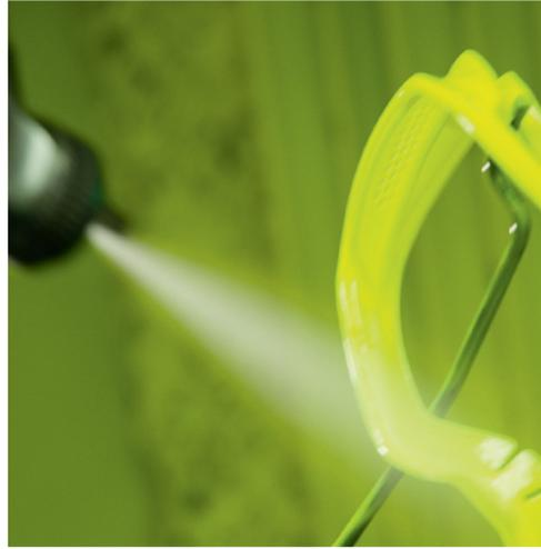
**16 – Farbdekoration** Für eine homogene Farbe werden Brillen in einem isolierten Raum einzeln und manuell mit Farbe besprüht.
