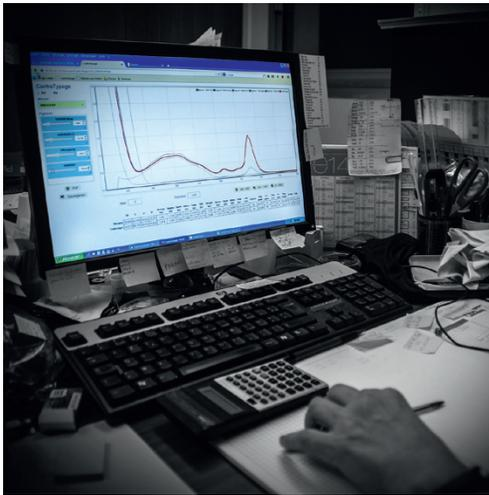
**6 – Scheibentönungen** Die gründliche Analyse der verschiedenen Wetter- und Lichtkonditionen dient der Abstimmung der Scheibentönungen auf den Einsatzbereich. Je nachdem werden andere Farben verstärkt oder herausgefiltert.
