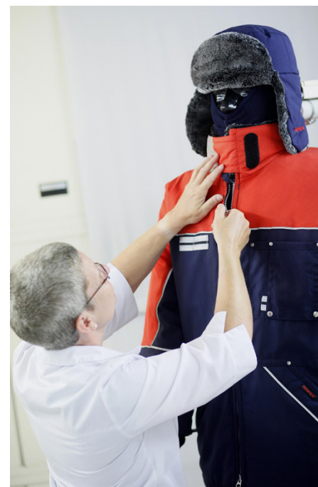
Die Wärmeisolation von Bekleidungsstücken wird an den Hohenstein Instituten unter anderem mit der thermischen Gliederpuppe Charlie ermittelt.
